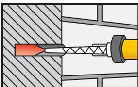
8. Injetar a resina no furo, encostando o bico do cartucho ao fundo e ir lentamente recuando até à superfície. Evitar a oclusão de ar. Para furos de ancoragem muito profundos podem utilizar-se tubos extensores.
