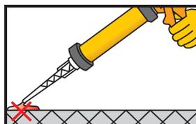
7. Extrudir a resina aproximadamente duas vezes até que ambos os componentes pareçam misturados. Não utilizar este material. Só iniciar a utilização da resina quando a cor do material extrudido for perfeitamente uniforme.
