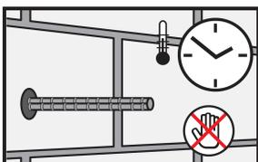
10. Durante o endurecimento da resina o varão não deve ser movido ou submetido a cargas.
