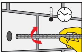
9. Inserir o varão com movimento rotativo no furo cheio de resina. Deve haver um refluxo de parte da resina para o exterior.
