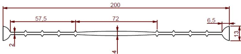
Lâmina de estanqueidade centralmente colocada, adequada para juntas de construção. Instalação no centro de estruturas de betão. Fixação fácil de Sika Waterbar® V-20 L SH para reforço com clips de fixação especiais (5 peças por m).
